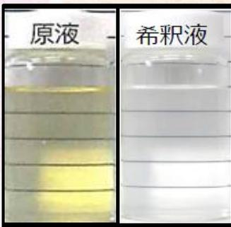
潤滑剤に優れた合成油を基本油としており、鉄系材料の切研削加工に適しています。独自のバイオスタティック技術等の相乗効果で優れた防錆性を発揮します。界面活性剤を一切使用していないため、混入油分の分離性に優れており、液の透明度を長時間維持します。消泡性に優れており、高圧クーラント使用の機械でも泡立ちの心配がありません。砥石のドレインインターバルを1.5倍延長できた実績あり！
